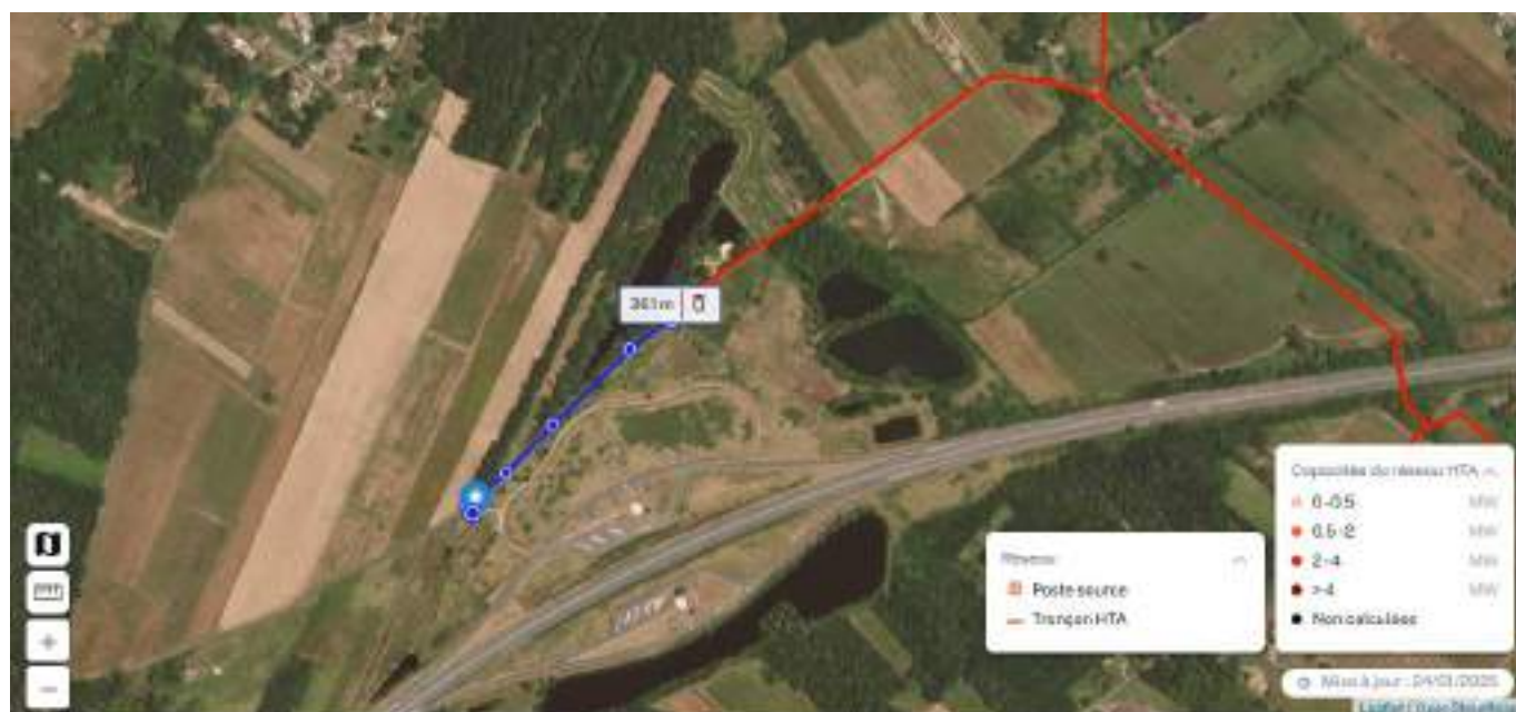
Illustration 6 - Tracé prévisionnel du raccordement envisagé de l'installation photovoltaïque au point de piquage (source Solarvia)
