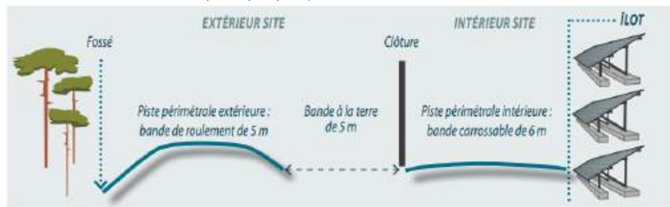
Pistes périmétrales intérieure et extérieure à la clôture - Schéma 1
